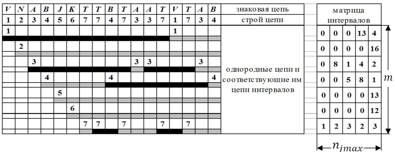
Рис. 1.9. Декомпозиция строя неоднородной знаковой цепи на неполные однородные цепи и матрица их интервалов
